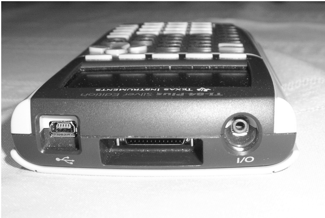
Figure 5.1 Les trois ports de communication d'une calculatrice TI-84 Plus Silver Edition (version professeur), de gauche à droite : le port USB, la sortie vidéo et le port I/O.
