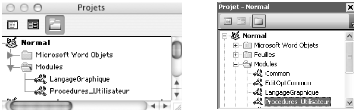
Figure 2.1 Pour faire apparaître la fenêtre « Normal - Procedures_Utilisateur (Code) », double-cliquer sur l'item « Procedures_Utilisateur » de la fenêtre « Projets » (version Macintosh ) ou « Projets - Normal » (version Windows ).
