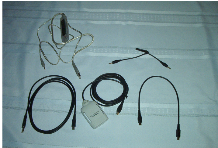
Figure 5.3.2 Les câbles de branchement I/O (en haut) et USB (en bas) : à droite, pour relier deux calculatrices; à gauche, pour relier calculatrice et ordinateur; au centre, pour transformer le port USB en sortie vidéo.
