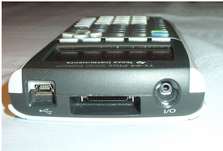
Figure 5.3.1 Les trois ports de communication d'une calculatrice TI-84 Plus Silver Edition (version professeur), de gauche à droite : le port USB, la sortie vidéo et le port I/O.
