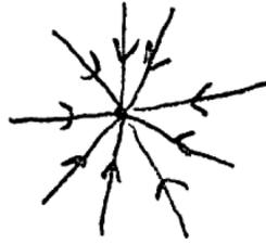
**Corollaire 3.18.** *La position d'équilibre  $\begin{pmatrix} 0 \\ 0 \end{pmatrix}$  du pendule avec friction est asymptotiquement stable.*
